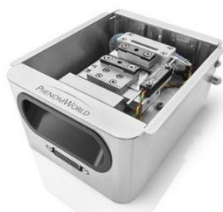
sledování vzorků při namáhání tahem (1000 N)
